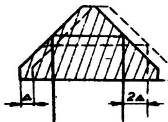
Obr. 15.4.11 Posuv optické osy vyvolaný posuvem hranolu.
