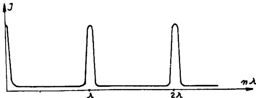
Obr.13.2.2 Průběh intenzity ve výsledném svazku Fabry-Perotova interferometru v závislosti na měnící se optické tloušťce nd .
