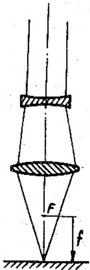
Obr.2.3.4.1 Chevalierova lupa s velkou pracovní vzdáleností
