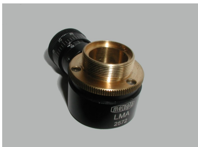
Obr. 2 Světelná pinzeta pro mikročástice pro napojení externího laseru LMA 2 (KOPOL 808 nm).
