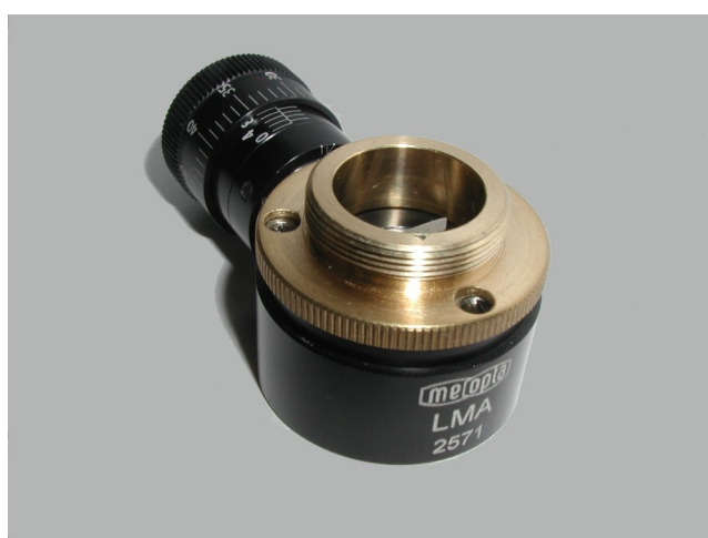
Obr. 3 Ozařovací systém pro mikroskopovou techniku FRAP na bázi přístroje LMA 2 - 405 nm.
